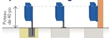
1. Monter sur un poteau de 4 x 4 traité sous pression et cimenté au sol
